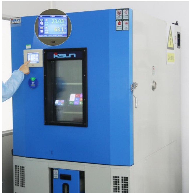
图 4-5 高低温老化测试图
